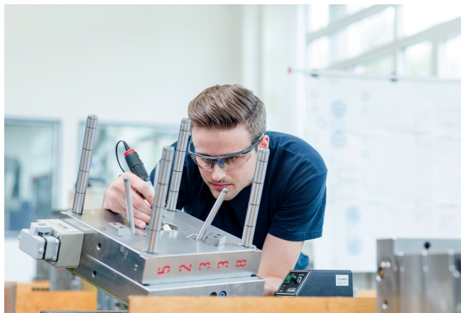
Alle für die Montage benötigten Bauteile werden unter strengsten Qualitätsvorgaben im Wirthwein-Werkzeugbau gefertigt und in die Spritzgießwerkzeuge integriert. © Wirthwein Medical
